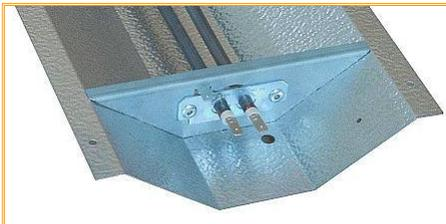
Der **RS – Rückenreflektor** hat die Aufgabe, die Strahlungsenergie auf kurze Distanz abzumildern und in die Breite zu verteilen, damit eine nah davor sitzende Person die Strahlung als mild und angenehm empfindet. Das wird erreicht durch die Breite Form des Reflektors, der die Energie in einem Abstrahlwinkel von ca. 120° aussendet.
