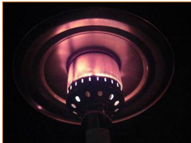
Wird dieses Heizgerät jedoch gedrosselt und der Glühkörper glüht nicht mehr, wird nur noch eine langwellige Infrarot ‚C‘ Strahlung erzeugt, die kaum noch Reichweite aufweist.
