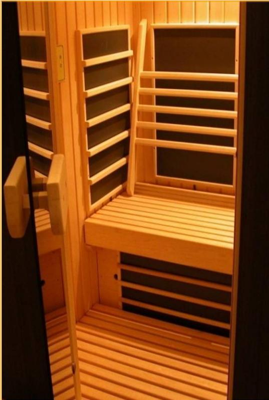
Flächenstrahler sind großflächige Heizplatten, die üblicherweise an der Rückwand der Infrarot Wärmekabine, rechts und links der Sitzbank, unter dem Holzrost von Sitzbank und Fußrost, sowie im Wadenbereich montiert werden.
