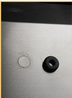
Brechen Sie an der später aufliegenden Seite, z. B. mit einem Schraubendreher, die entsprechende vorgestanzte Öffnung zum Herausführen des Anschlusskabels aus dem Gehäuse..
